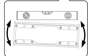
**Увага!** Після встановлення кронштейну перевіріти надійність його кріплення до стіни.
