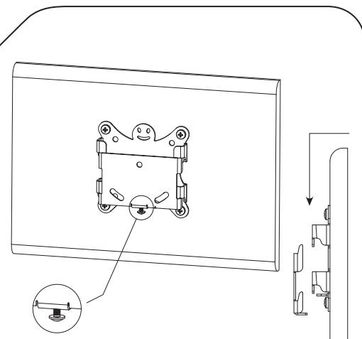
Навісити панель телевізора з кріпленням **B** на пластину **A**. Повністю викрутити виділений на малюнку фіксуючий гвинт в отвір **1**.
