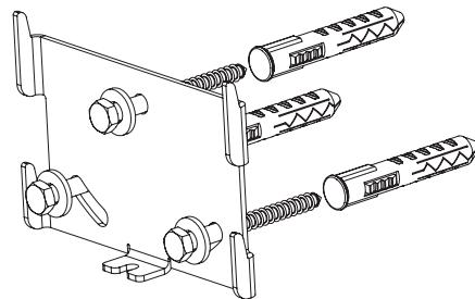
Використовуючи кронштейн **A** у якості шаблону, а також рівень з комплекту інструментів, розмітити місце встановлення кріплення; отвори повинні розташовуватись горизонтально. Використовуючи перфоратор, просвердлити 3 отвори у стіні діаметром 10мм і глибиною не менше 60 мм. Вставити дюбелі **C** в отвори. Закріпити кронштейн **A** на стіні, використовуючи шурупи і шайби з комплекту **C**. При необхідності довести положення кронштейна **A** до горизонтального, прокрутити його в овальних отворах.
