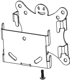
Викрутити повністю фіксуючі гвинти внизу кріплення. Після чого роз'єднати кронштейн **B** і кронштейн **A**.
