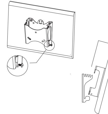
Навісити панель телевізора з кріпленням В на пластину А, вибралиши необхідний кут нахилу панелі. Повністю вкрутити фіксуючі гвинти в отвори 1.
