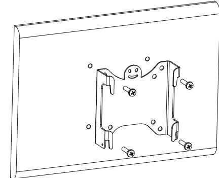
**Увага!** Після встановлення кронштейну перевірити надійність його кріплення до панелі телевізору.
