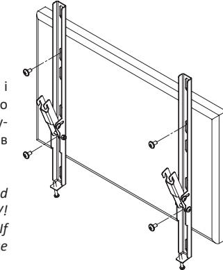
**Увага!** Після встановлення кронштейну перевірити надійність його кріплення до панелі телевізору.
