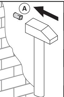
**Увага!** Після встановлення кронштейну перевірити надійність його кріплення до стіни.
