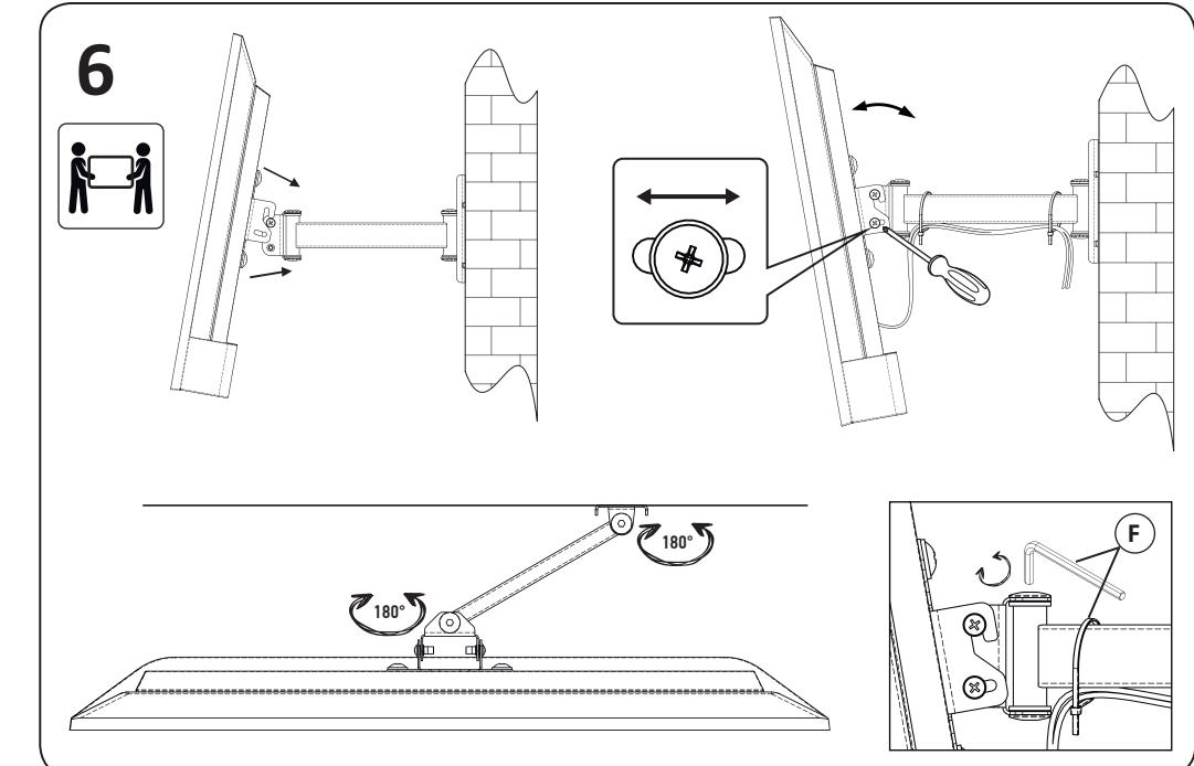
Увага! Після встановлення кріпильної планки перевірите надійність її кріплення до панелі телевізору.
