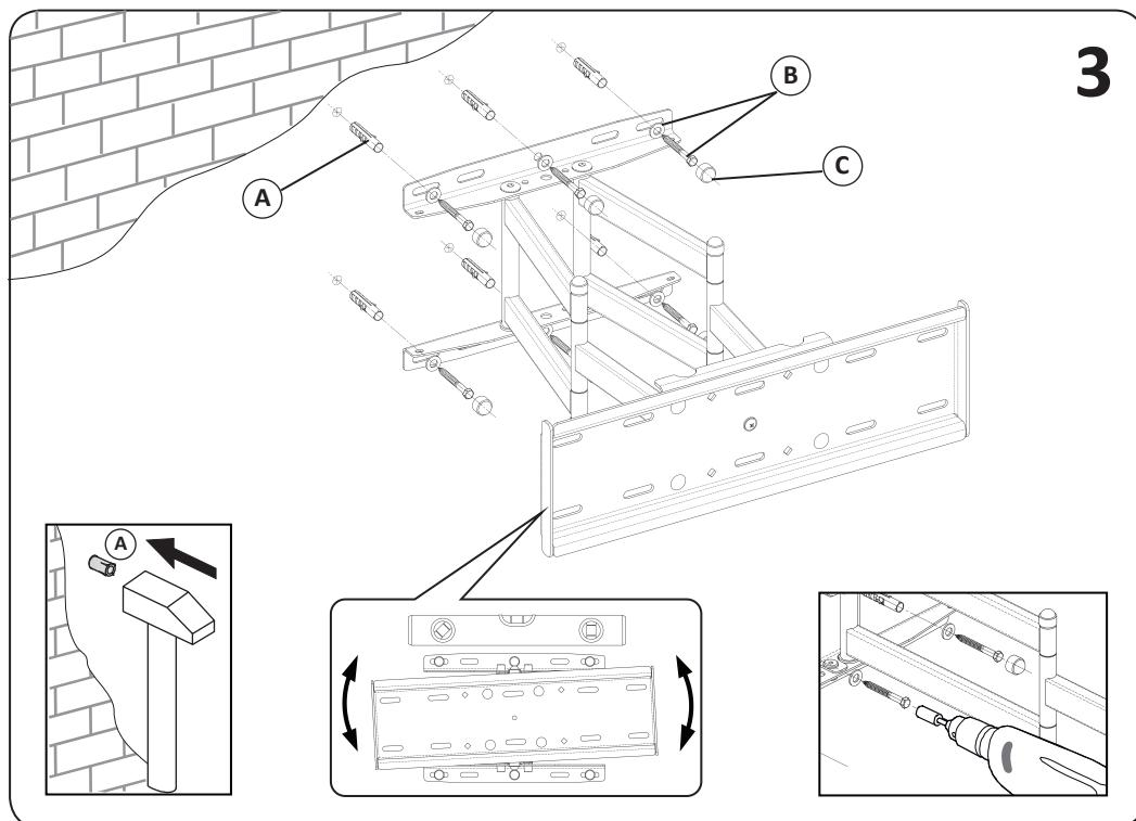
**Увага!** Після встановлення кронштейну перевіріти надійність його кріплення до стіни.
