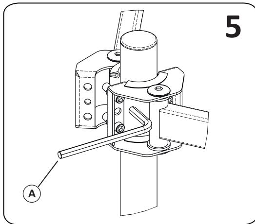
**Увага!** Після встановлення кронштейну перевірити надійність його кріплення до столу.
