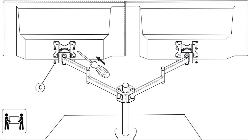
**Увага!** Після встановлення кріпильної планки перевірити надійність її кріплення до монітору.
